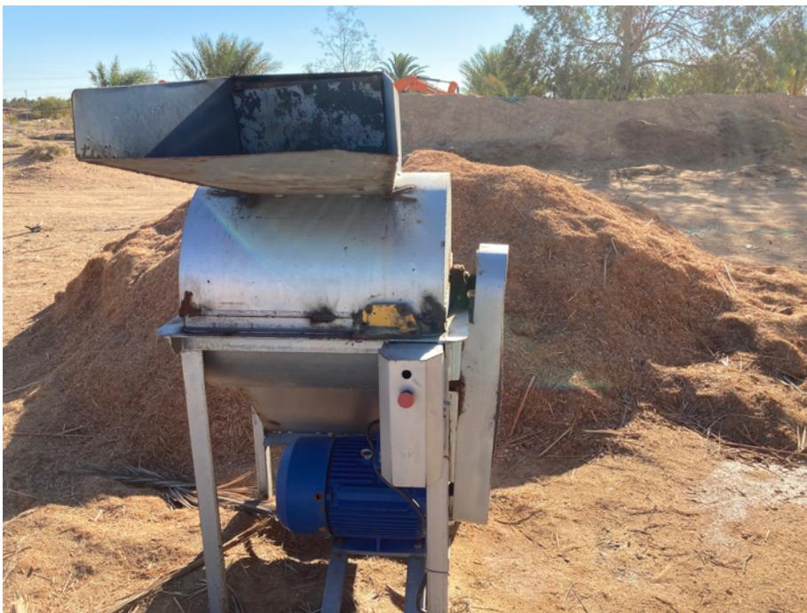
Figure 4 Broyeur de biomasse ligneuse installé dans une installation de compostage à Biskra
